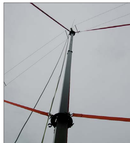
T2FD-Antenne, absolut bewährt für den Notfunktinsatz Fotos: DH3HDW
