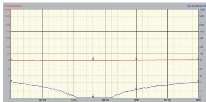
Bild 9: Impedanz (rot) und SWV (blau) nach Abgleich der Aufstockkabel, angezeigt durch die PC-Software zum Antennenanalysator FA-VA
