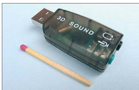
Bild 1: USB-Soundkarte im Steckergehäuse mit einem Streichholz als Größenvergleich
