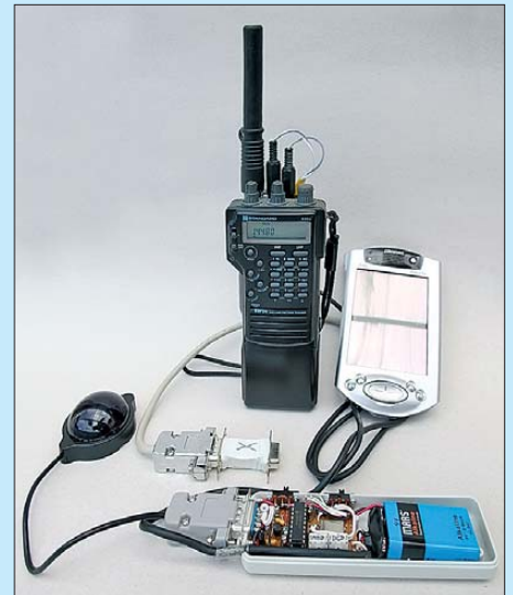
Bild 3: APRS portabel mit einem Eigenbau-Tracker, einem GPS-Empfangsmodul und einem Palmtop als Anzeige- und Konfigurationsgerät
