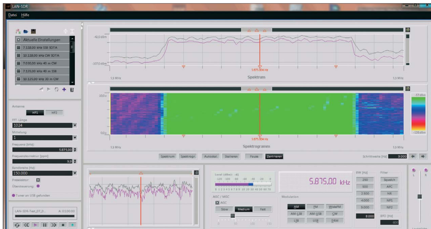
Bild 4: Die Bedienoberfläche zeigt auf Wunsch Signale (hier DRM auf 5875 kHz) gleichzeitig im Spektrum und im Wasserfalldiagramm.
