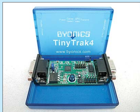
Bild 4: Durch SMD-Technik ist im Gehäuse des TinyTrak4 noch Platz für Zusatzschaltungen oder eine Stromversorgung.
