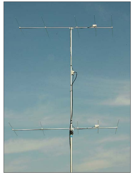
Bild 7: Zwei je 2 m lange 5-Element-Yagis gestockt
