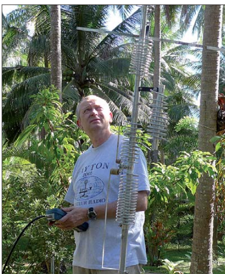
Manfred, DK1BT, beim Abgleichen der HF9V-Vertikalantenne
