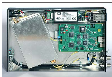
Bild 2: Blick ins Innenleben der Hardware: Die beiden Antenneneingänge werden zunächst einem Preselektor zugeführt.
