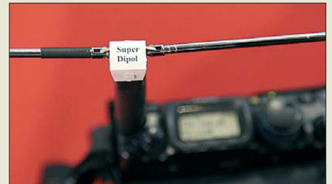
Interessante Antennenlösungen für Portabelbetrieb, wie hier ein aufsteckbarer Teleskopdipol für 2 m und 70 cm, gab es am Stand von lambdahalbe.de zu kaufen.
