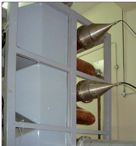
6-Zoll-auf-N-Adapter, der Weg zu den größten Antennen der Welt ist gebahnt.
