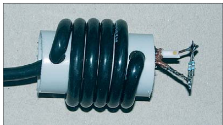
Bild 8: Ausmessen der Aufstockkabel mit 25-Ω-Abschlusswiderständen
