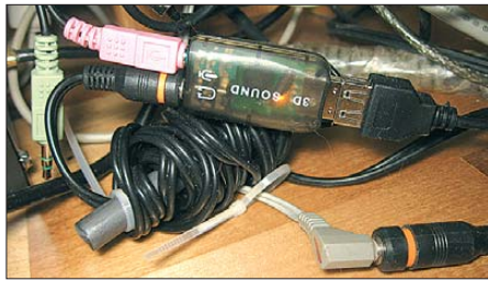
Bild 3: Angeschlossene USB-Soundkarte, darunter das improvisierte Filter für den Audioausgang Fotos: SM5ZBS
