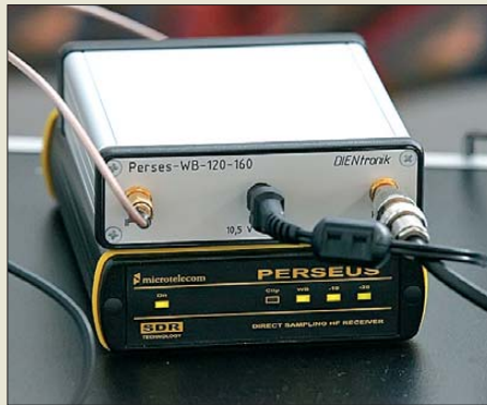
Der breitbandige Konverter Perseus-WB von Dientronik erweitert direktabtastende SDR, je nach Modell, um den Empfangsbereich 40...80 MHz, 80...120 MHz oder 120...160 MHz.
