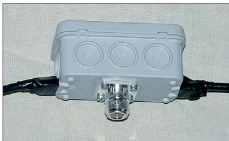
Bild 5: Das System hat nur eine N-Buchse zur Speisung
